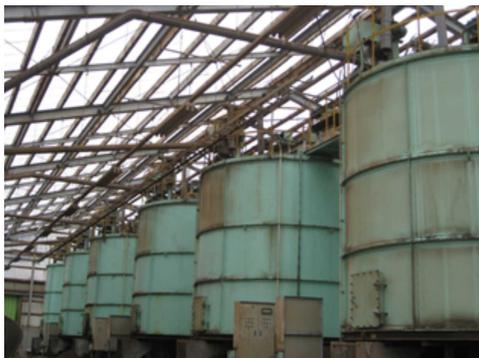
6基のコンボはポリカーボネートで囲った建物の中に収容されており、豚舎と同じく脱臭装置がすべて取り付けられている
