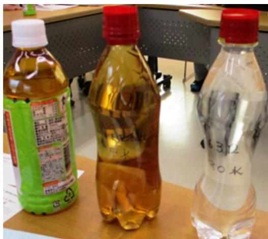
汚水はばっ気処理したあと、MF（中空糸）膜とRO（逆浸透）膜装置で高度膜処理を行う。MF膜を通してできた「中水」（写真中央）は市販のお茶（写真左）とほぼ同色、RO処理でできた「上水」（写真右）は豚舎洗浄と飲水に使用している
