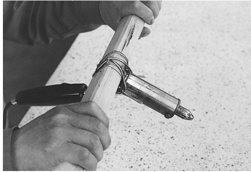
図 12.21 手製の「錠剤化凍結精液製造用 ドライアイス穿孔器具」
