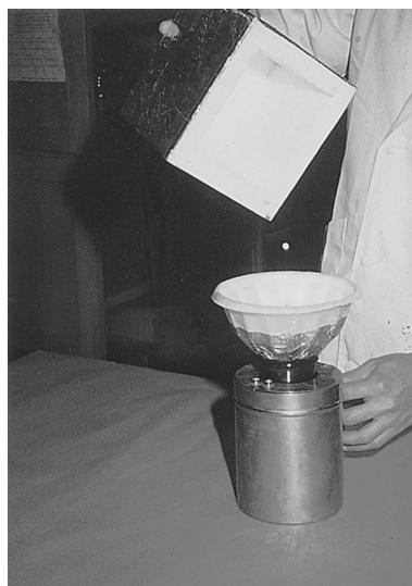
図 12.29 液体窒素 ( $-196^{\circ}\text{C}$ ) から取り出したペレットを発泡スチロール・ボックス内に約 3 分間放置後、加温した融解液中に投入して融解する方法 (旧法)。
